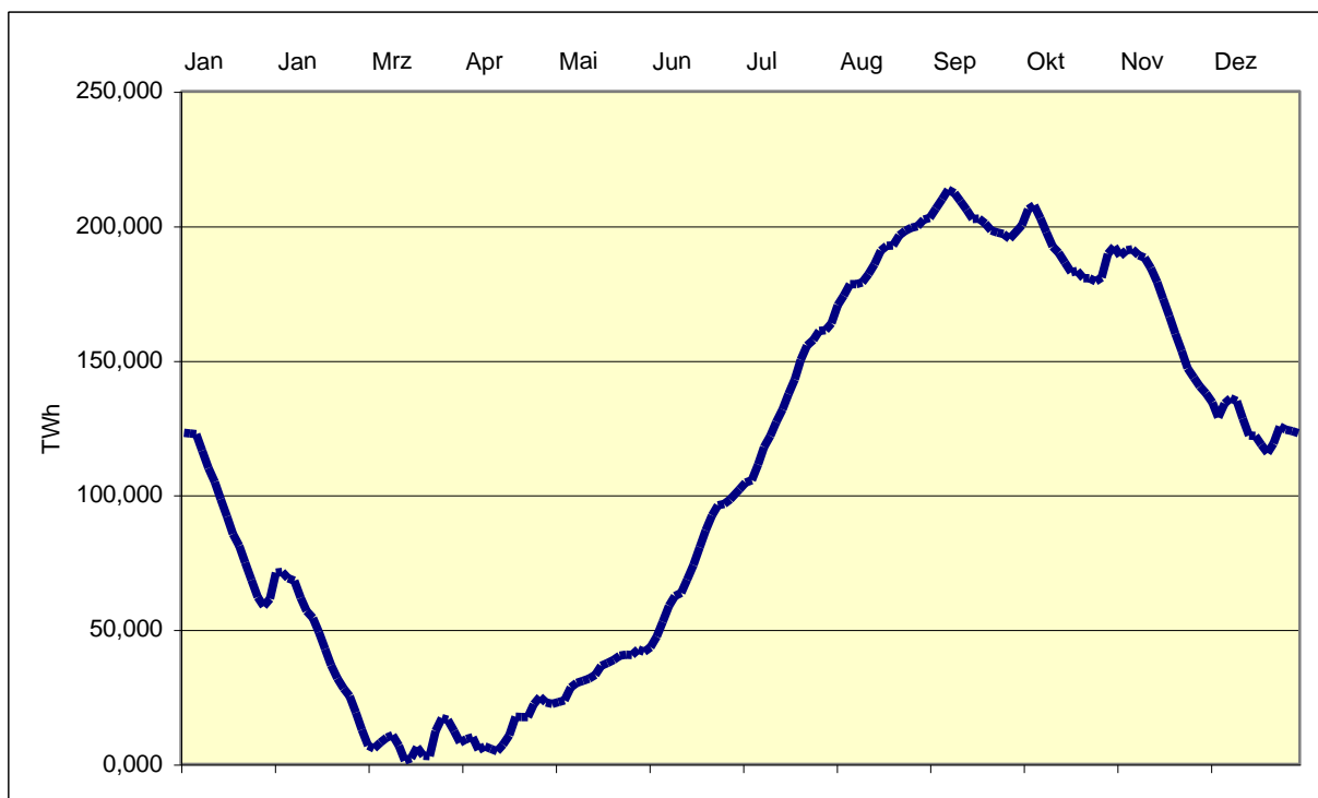
Abb. 10: Lade-/Entladezyklus der Speicher für eine Energieversorgung aus regenerativen Quellen, Wind/ Solarstromerzeugung = 1,6:1
